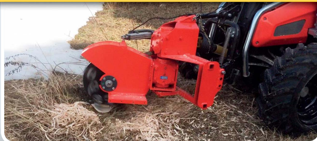
Die PTH WSF ist eine kompakte Wurzelstockfräsmaschine für all jene die Ihre Baumstümpfe in schwer zugänglichen Bereichen bearbeiten wollen.
