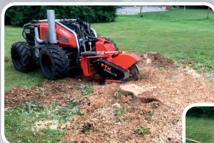
Der Bearbeitungsbereich der Maschine wurde für die Zerspannung von Baumstümpfen aller Art ausgelegt und garantiert einen größtmöglichen Schwenkradius. Größere Baumstümpfe sind ebenfalls möglich wenn die WSF mit dem Trägerfahrzeug etwas umgesetzt wird.
