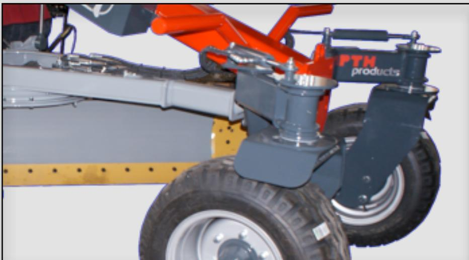
Hydraulische Hilfslenkung über Zylinder
