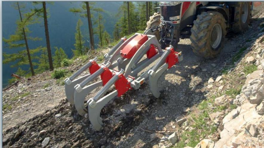
Spiralfeder belastete Zinkensicherung
